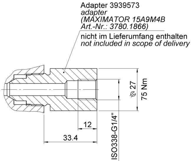
**Anschluss "P" mit MAXIMATOR-Verrohrung**
